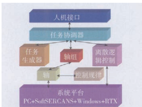
图2 开放式运动控制器的模块化结构
